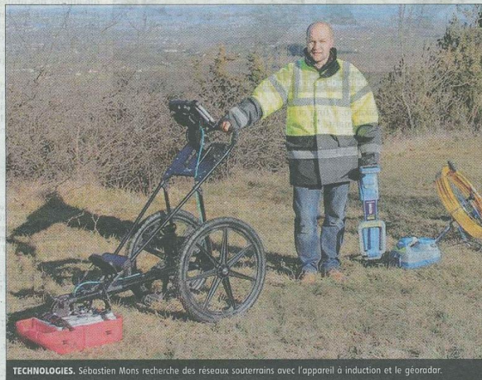
TECHNOLOGIES. Sébastien Mons recherche des réseaux souterrains avec l'appareil à induction et le géoradar.
